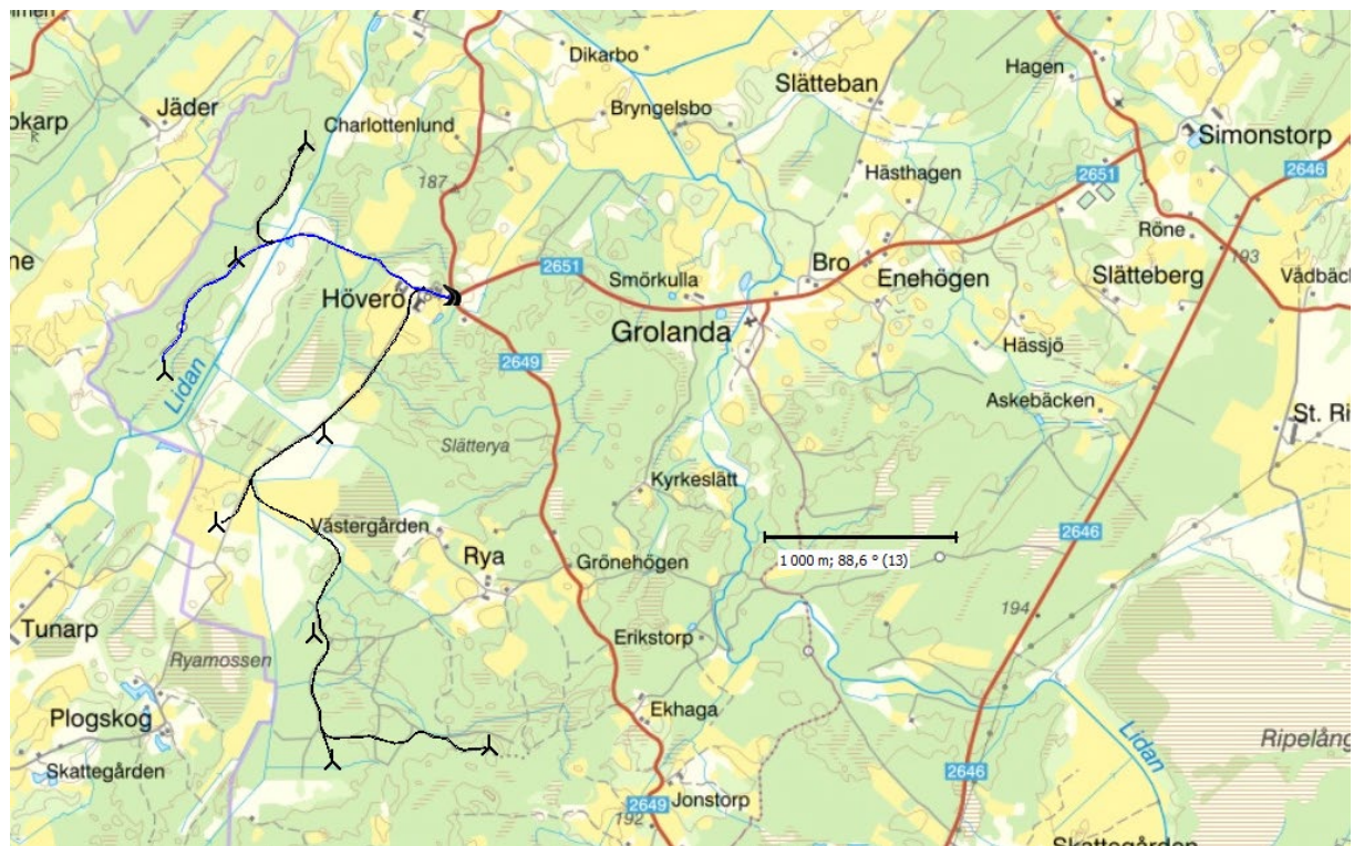
Figur 5. Preliminärt förslag på vägar inom vindparken (layout med 8 verk). Utanför projektområdet kommer troligtvis väg 2651 genom Grolanda användas för transport av delar till vindkraftverken.
