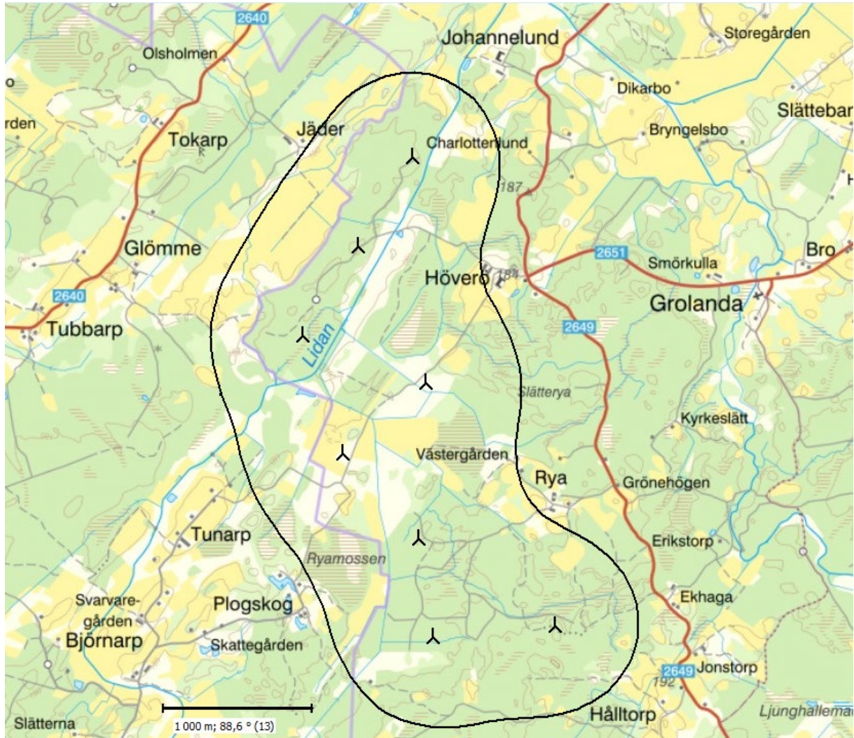
Figur 6. Ljudberäkning enligt det preliminära förslaget på vindkraftverksplaceringar med 8 vindkraftverk. Ljudberäkningen är gjord med vindkraftverk av modellen Siemens Gamesa SG 6,0 – 170 med 165 meters torn och 170 meters rotordiameter. Den svarta linjen visar den beräknade ljudnivån 40dB(A).
